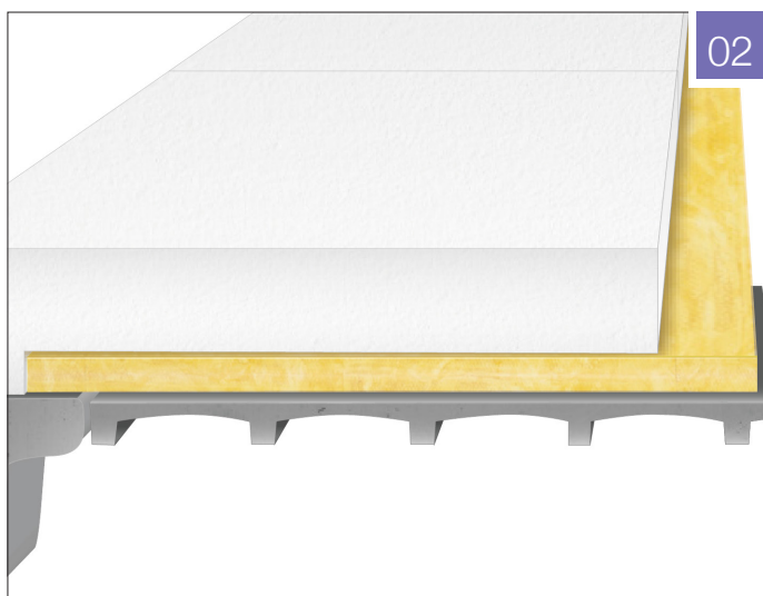
Fig. 02: Opbygning på TTS og vaffelbetonplader
